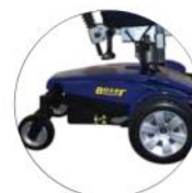
Ruota motrice centrale
